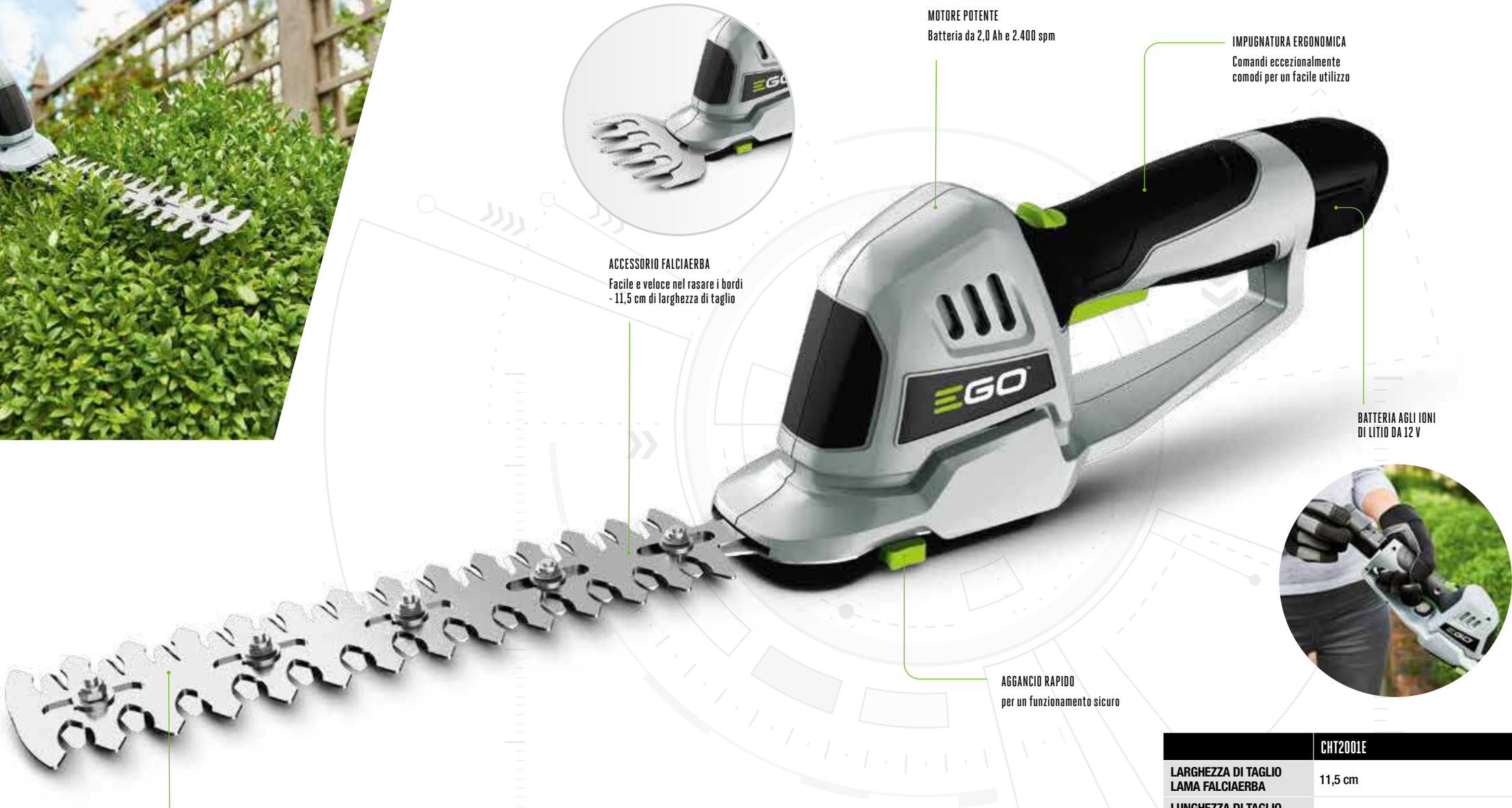
ACCESSORIO TAGLIESIEPI Lama da 20 cm tagliata al laser facile da sostituire e con capacità di taglio di 8 mm
